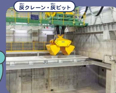
14 灰は、灰ピットに運ばれ、埋め立て処分したり、一部リサイクル原料として利用されます。
