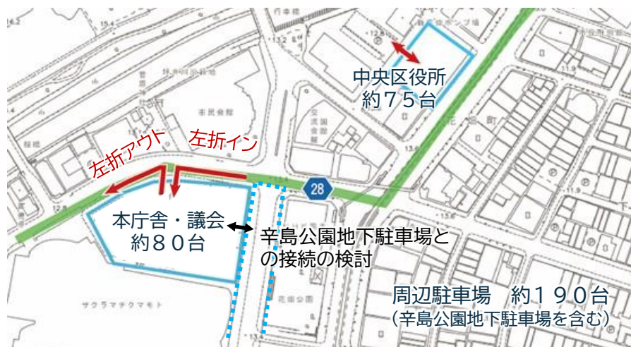
【 図 20 新庁舎の駐車場出入口 】
