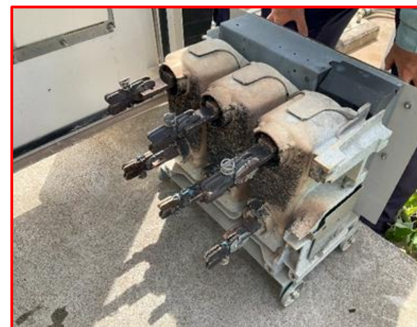
③ 焼損した機器（VCB） ※端子が焼け焦げている
