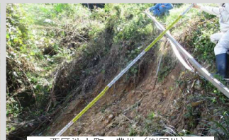
西区池上町 農地(樹園地) 法面崩壊L=6.5m
