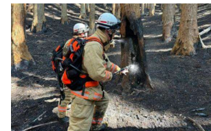
▼背負い式消火水のう ※林野火災での残火処理
