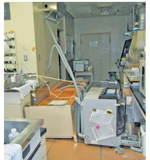
落下した検査機器
