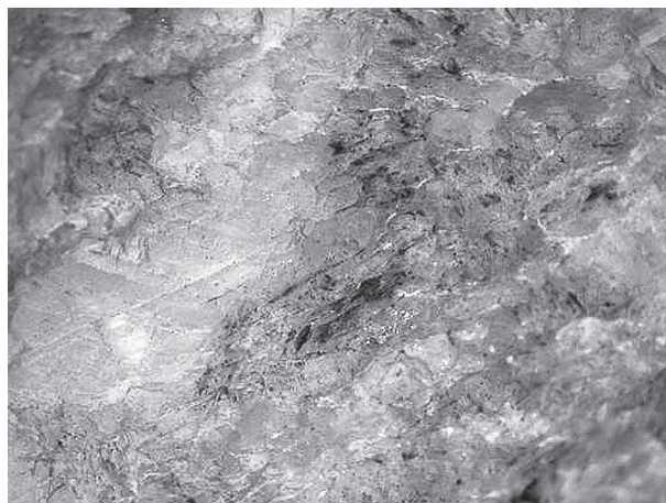
写真 5-2 1 の実体顕微鏡写真 ※長柱状の大きな方解石結晶写真の下辺 13.5 mm
