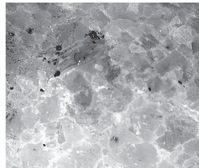
写真 2-12 GR31 (4/4) 実体顕微鏡写真 ※石墨点在方解石等粒状
