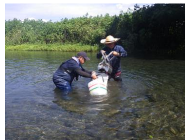
図 3-23 調査のため 湖内底質を採泥する様子
