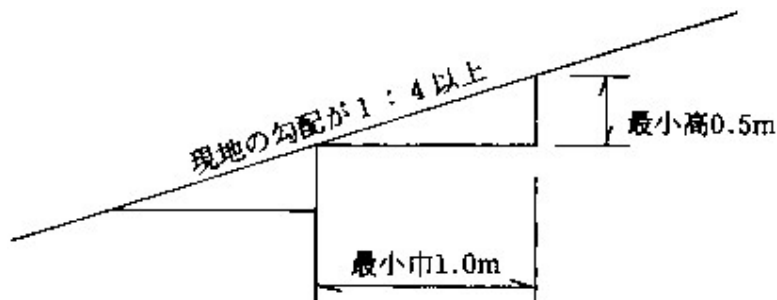
図4-1 盛土基礎地盤の段切
