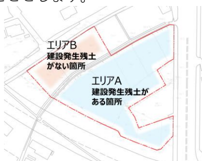
図 4-19 施工エリア区分
