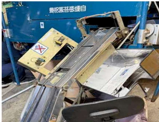
付属設備（海苔選別機）の破損
